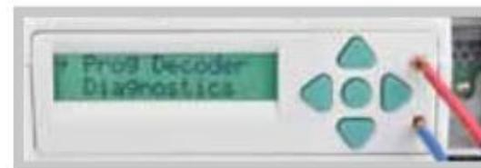
3. Вставьте синий провод от дешифратора в другое отверстие порта программирования.
